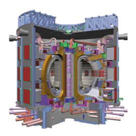
Vue de la maquette à trois dimensions du *Tokamak* ITER, projet international visant à produire de l'énergie par la fusion thermonucléaire dans un dispositif à confinement magnétique. Le mannequin permet d'apprécier les dimensions de l'installation. La réaction nucléaire mise en jeu est : Deutérium + Tritium → Hélium 4 + neutron. Le coût du projet est évalué à 4,7 milliards d'euros sur 10 ans.
